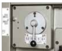
Automatischer Bohrvorschub 0.05, 0.1, 0.2 mm/U
